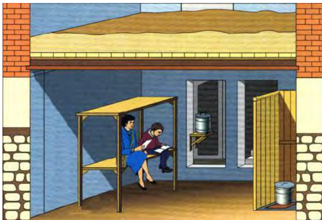
Рис. 4 — Подвал, приспособленный под укрытие
